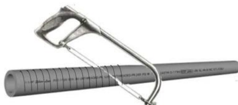
Gambar 16. Gergaji besi untuk resapan air untuk pipa yang akan diletakkan paling bawah
